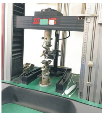
图10 试品拉伸试验状态图
