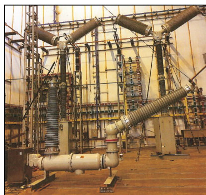
图2 开断试验状态图
